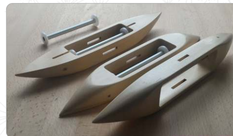
Челнок-лодочка без дна (челнок 30 см, шпульная коробка 12 см). Материал: липа.
